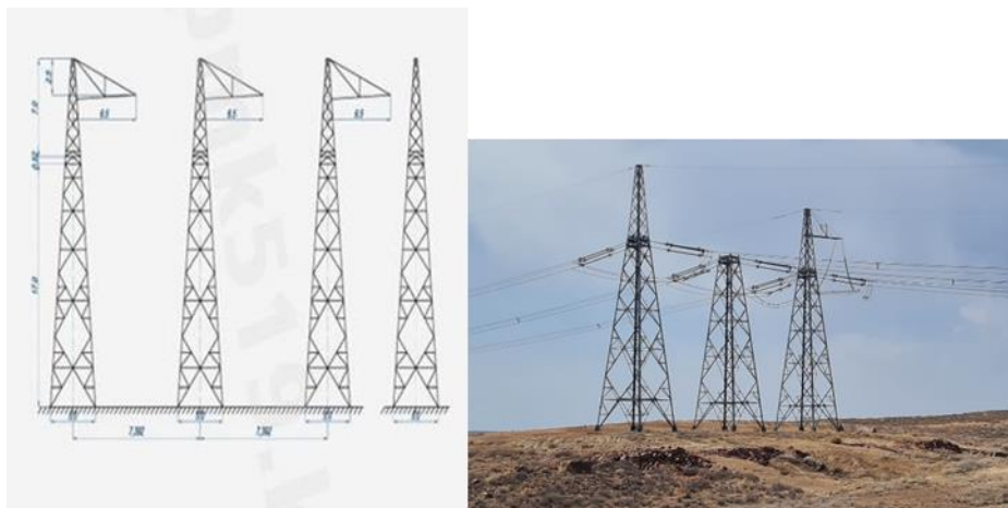
Рисунок 13: Конструкция №3: Трехстоечные решетчатые свободно стоящие опоры
